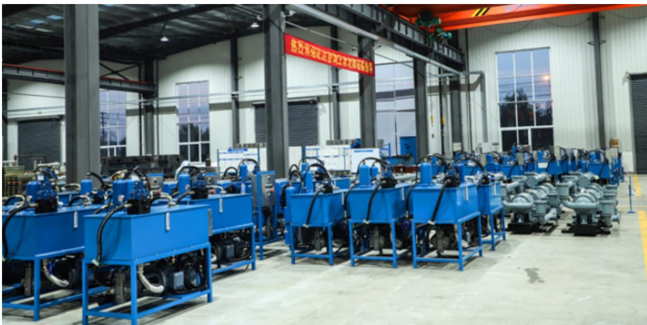
客户在使用节能泥浆泵的过程中，可以根据泥浆泵产品使用说明书定期进行检查、维护，在检查中如遇到不出油、压力不足的问题，可以首先检查一下电机转向正不正确，吸油管或过滤器是否堵塞，再看连接处是否泄漏，混入了空气，\*\*\*就是检查油箱内的油液粘度。如果有类似以上的问题，客户无需惊慌，现场人员可以自行解决该故障，调换电动机两相连接，对管道进行疏通，清洗过滤器，换上正规正确的新油，更换密封件，避免泄漏，严防空气混入。节能泥浆泵在设计时考虑到稳定、抗震、安全。安徽电镀节能泥浆泵联系方式
