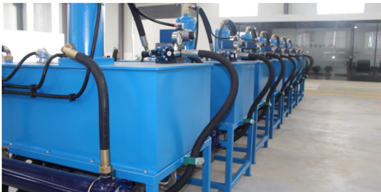
节能泥浆泵可运用于煤炭洗煤行业。洗煤行业的行业特点为洗煤量大，要求效率高，一般20-30分钟一个循环，是污泥处置效率的5-10倍；煤泥颗粒度细且硬度高，对设备有一定的磨损；电机能耗高，一般电机功率在75-160KW之间，有些功率还要高；传统煤炭行业使用的泵维修频率高，维修成本居高不下，在日常的维修维护中还需要配备专业的维修人员。针对该行业特点，我公司研制出大流量双缸双进料设备，工作缸筒专门采用特殊合金治金融合而成，耐磨性大幅提高，寿命比普通碳钢材质提高10倍以上。节能泥浆泵的电机功率只需15-22KW比传统泵可节电80%左右。
